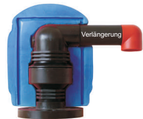
Frostschutzmantel für Typen D040-P /-PP /-VA aus Hartschaum, 2-teilig, für Temperaturen bis -20°C.
